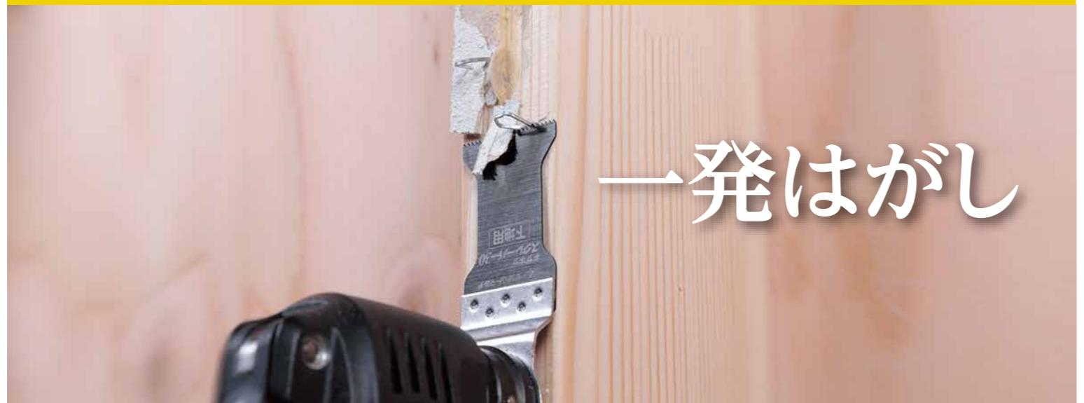
窓枠に残った木くず・接着剤のはがし作業に
